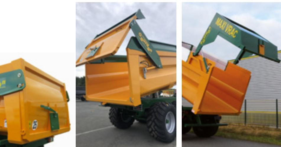
**PORTE AUTOMATIQUE à action pendulaire** | Gestion de l'ouverture et du flux en fonction de l'angle de bennage. Oscillation pour une vidange facilitée des matières compactes.
