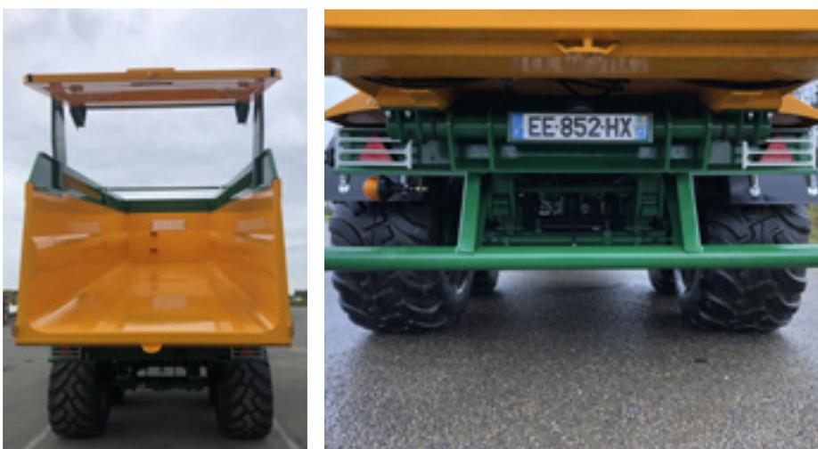
**CAISSE AU PROFIL CÔNIQUE** | Design moderne, écoulement et détachement de la matière dans sa totalité.
