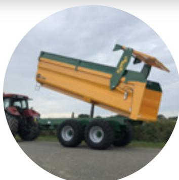
Avec une fabrication identique aux bennes grands volumes de la gamme GVM, les remorques de la gamme G *double essieux* vous garantissent également fiabilité et robustesse. L'encastrement de la caisse dans le châssis leur confère une grande
